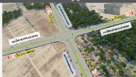
จุดตัด กม.ที่ 7+103 ตัดกับถนนสายหลัก (ทางแยกสัญญาณไฟจราจร)
